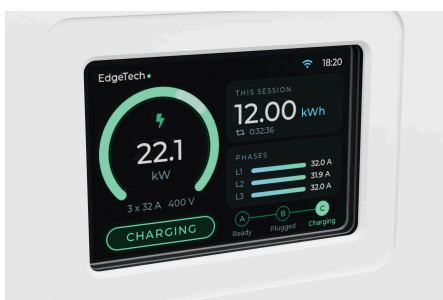
Het display: vermogen, energie in de laadsessie, stroom per fase, status
