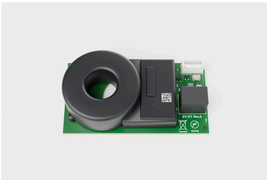
Sensorring voor de fase- en neutraaldraden, meetmodule en 4-polige connector
