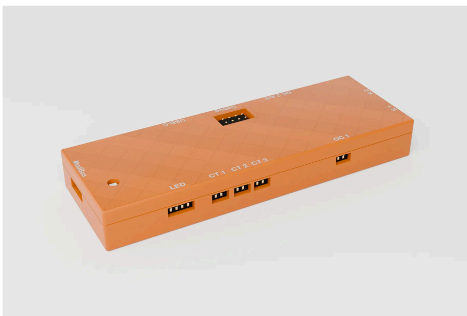
Stroomklemingen CT 1–3, led en open-collectoruitgang OC 1; Modbus aan het uiteinde
